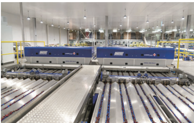
Fig. 1 Macchine per la calibrazione delle ciliegie equipaggiate con una tecnologia (Cherry Vision 3.0) per la rilevazione automatica di dimensioni, colore e difetti interni ed esterni, ammacature e contenuto in solidi solubili (°Brix).
